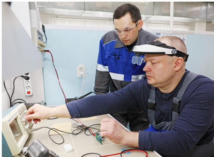
*Слесари по КИП и А Уренгойского газопромывлового управления в практической части подключали пожарные извещатели к приемно-контрольному устройству и монтировали схемы тактового генератора*
