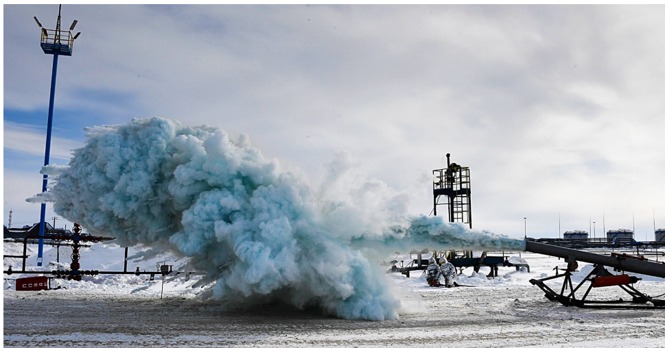
Установка пневматического порошкового пламяподавителя – эффективный инструмент тушения пожаров газовых фонтанов
