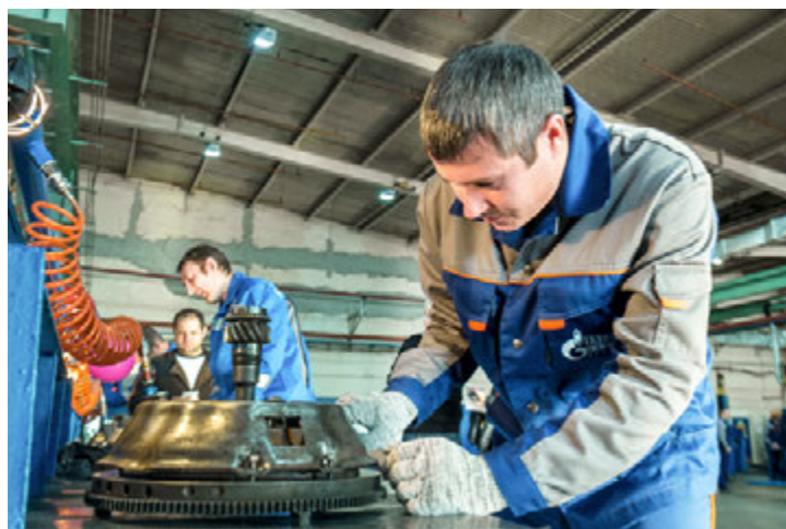
Слесарь по ремонту автомобилей Дмитрий Вшивков выполняет регулировку сцепления
