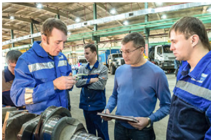
Слесарь по ремонту автомобилей Владимир Останин (на снимке слева) делает замер шеек коленвала
