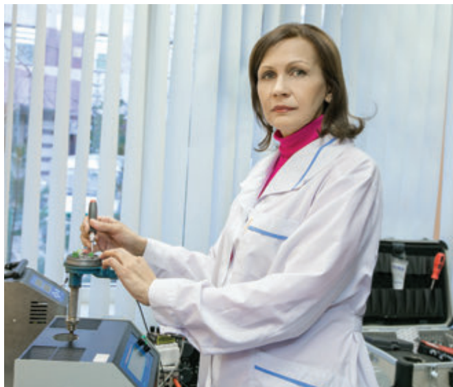
Слесарь по КИПиА службы метрологического обеспечения Елена Абрамова занимается проверкой термопреобразователей
