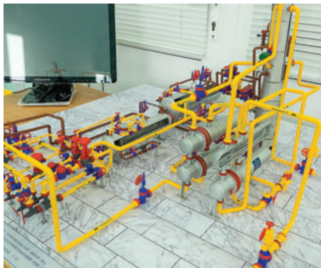
Макет технологической нитки № 6 второго газоконденсатного промысла, выполненный с помощью 3D-принтера
