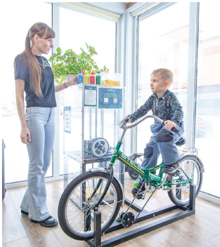
С помощью такого велосипеда пластиковые крышки измельчаются и отправляются на переработку
