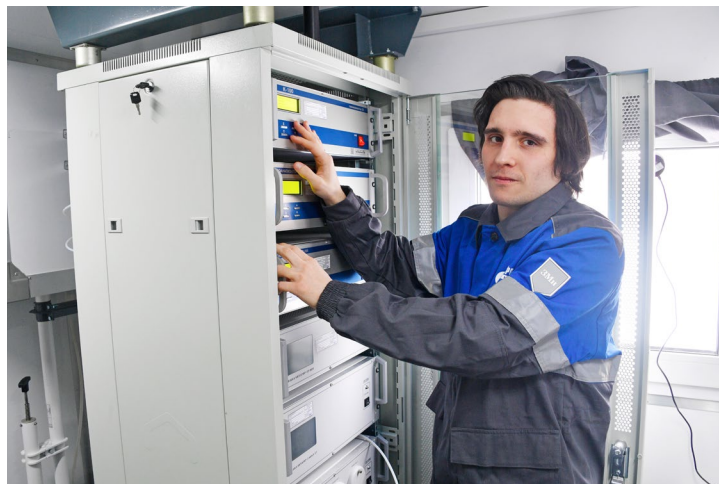
Лаборант химического анализа ИТЦ Илья Шмаков перекладывает режим газоанализаторов, расположенных внутри мобильной лаборатории
