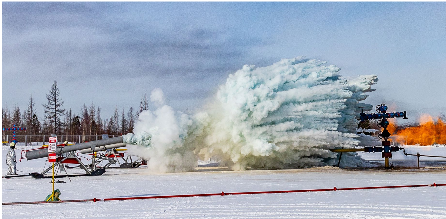
Порошковый подавитель пламени (ППП-200) российского производства заряжается двумястами килограммами порошка, который перекрывает огню доступ к кислороду
