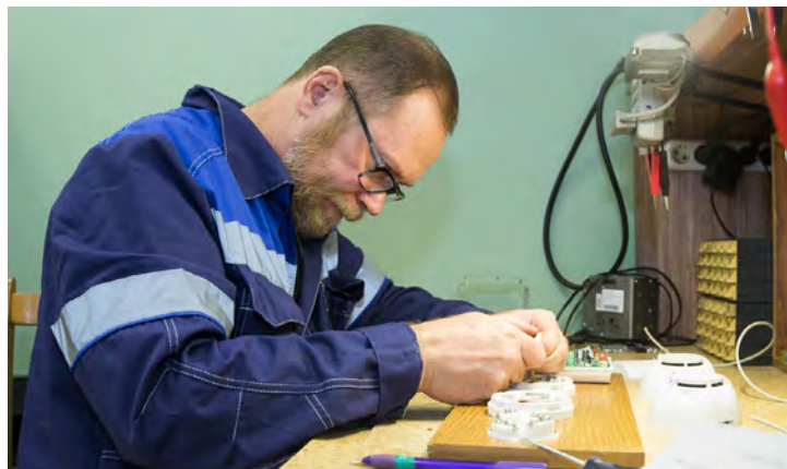
Сборкой шлейфа пожарной сигнализации занят слесарь по КИПиА УАиМО Александр Акимов
