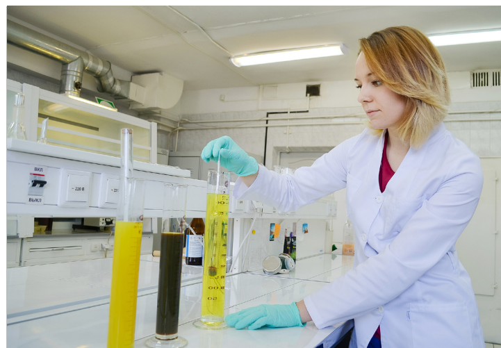
Лаборант химического анализа Ксения Попеску определяет плотность нефти и газового конденсата – валанжинского и ачимовского
