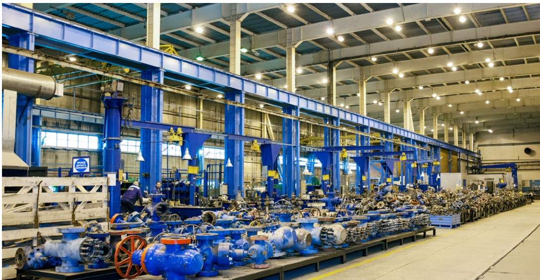
Цех по ремонту и наладке технологического оборудования
