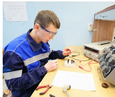
Дмитрий Реуков подключает термопреобразователь сопротивления по трехпроводной схеме измерения температуры
