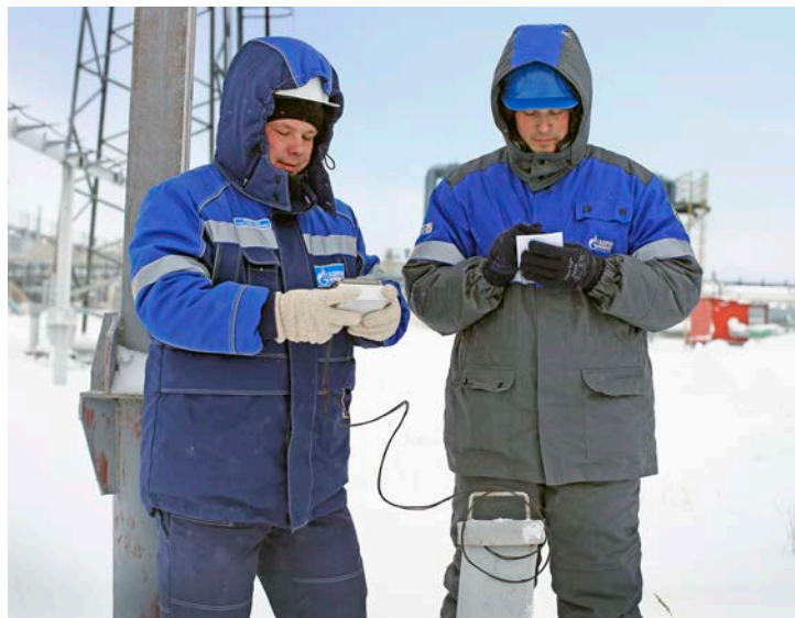
Инженеры Андрей Можейко и Алексей Цвицинский ведут термометрические наблюдения за температурой вечномерзлых грунтов
