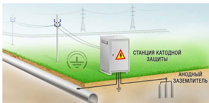
Принцип работы станции катодной защиты
