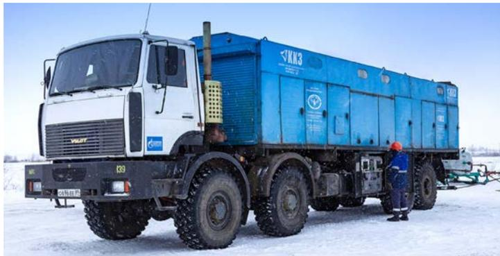
Азотно-компрессорная установка СДА-20/251 – помощник в процессе освоения скважины
