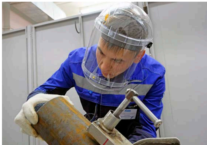
Подготовку кромки трубы под сварку выполняет слесарь-ремонтник УАВР Сергей Клочков. Работа спорится!
