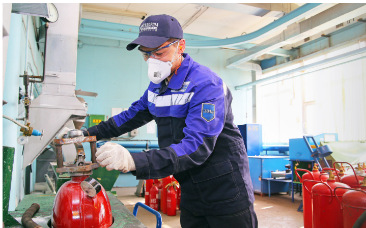
Слесарь-ремонтник Ильнур Гилязов производит разборку запорно-пускового устройства огнетушителя
