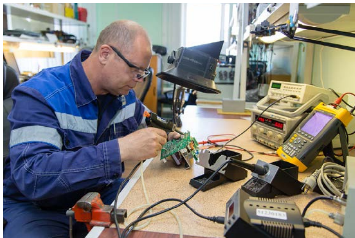
Участок техобслуживания и ремонта средств автоматизации цеха технической эксплуатации объектов инфраструктуры. Слесарь по КИПиА Александр Акимов в профессии почти 30 лет. С помощью паяльной станции, осциллографа, генератора низкочастотных сигналов он демонтирует неисправные элементы электронного блока питания, который был установлен на одной из ДКС
